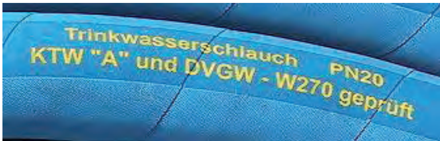
Abbildung 25: Korrekte Kennzeichnung auf einem Trinkwasserschlauch für ortsveränderliche Betriebsstätten.
